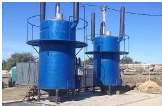
**Рисунок 5.11: Установки УПНШ (слева) и «Фортан» для обезвреживания отходов бурения, содержащих углеводороды**
