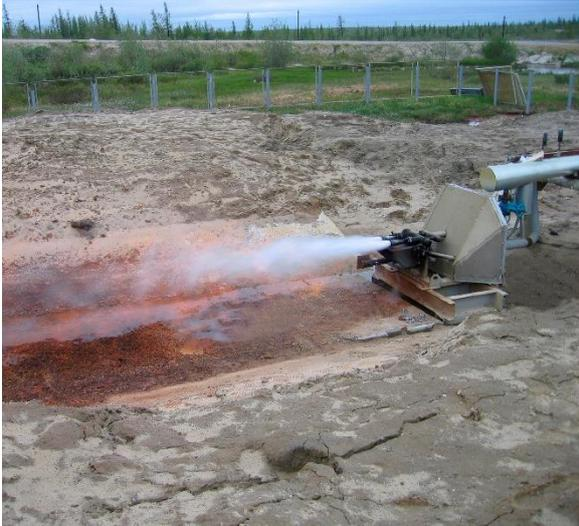
**Рисунок 5.9: Установка ГФУ-5 для утилизации очищенных сточных вод**
